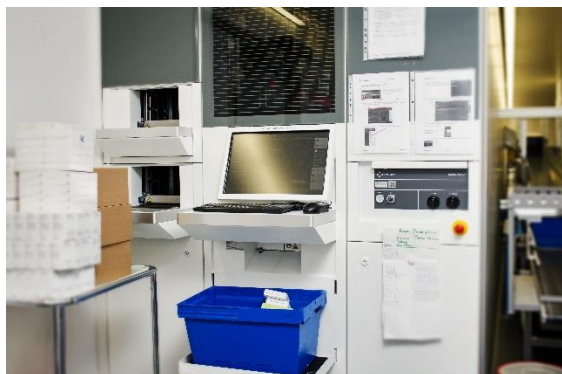
Kommissionier- und Lagerautomat «Rowa Vmax»: Aussenansicht
